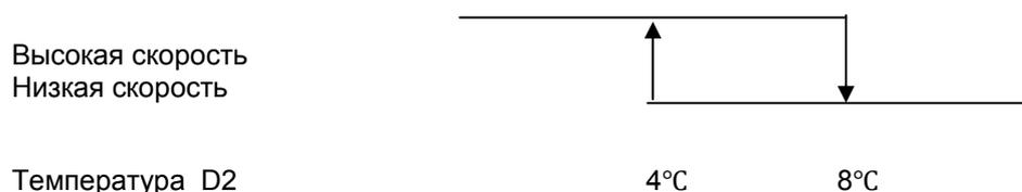
В режиме нагрева (отопление) после окончания процесса оттаивания, вентилятор испарителя включается на высокую скорость работы на 2 минуты, после чего переходит на нормальную скорость вращения.
